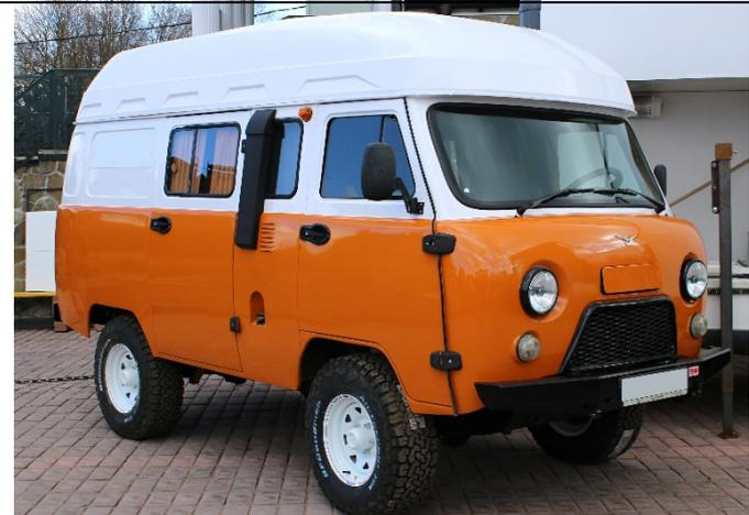
Рис. 6. Стационарная крыша Байкал-3С. В
