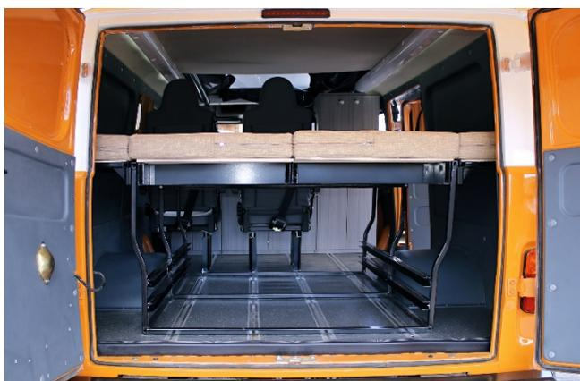
Рис.34. Изображение кровати в поднятом положении для транспортировки габаритного груза
