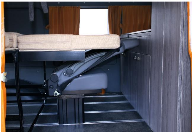
Рис.32. Изображение кровати при полном выдвигении (размер 1900x1460 мм)
