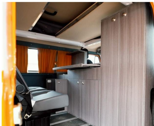
Рис.28. Изображение модульного комплекта мебели с открытым платяным шкафом
